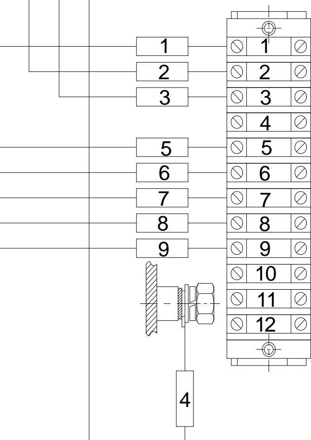
**Рисунок А.22 – Монтажная схема соединения коробки зажимов с контрольно-измерительными приборами**
