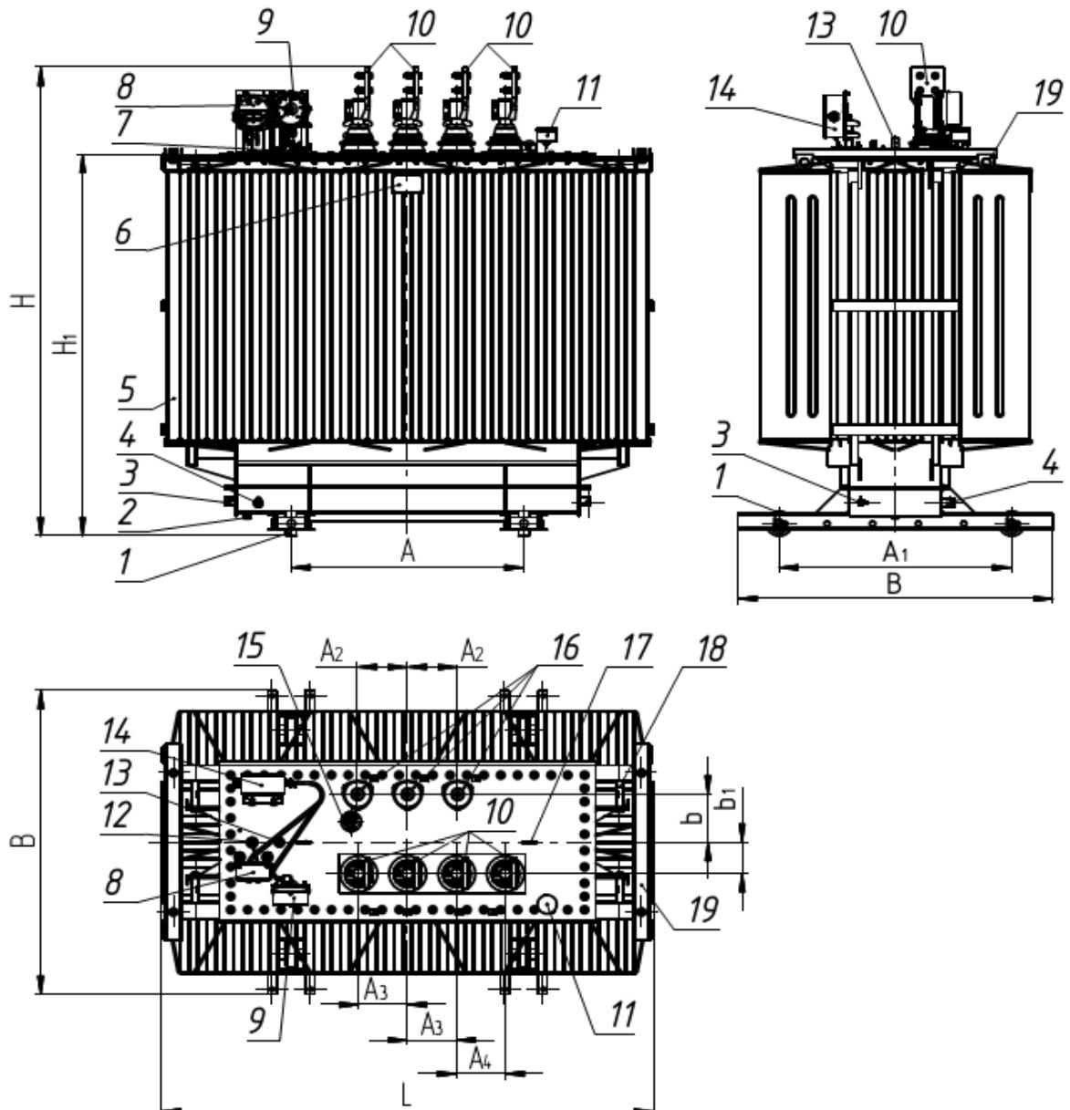
1 - ролик транспортный; 2 - пробка для удаления продуктов окисления и остатков масла; 3 - зажим заземления; 4 - пробка для слива масла;
