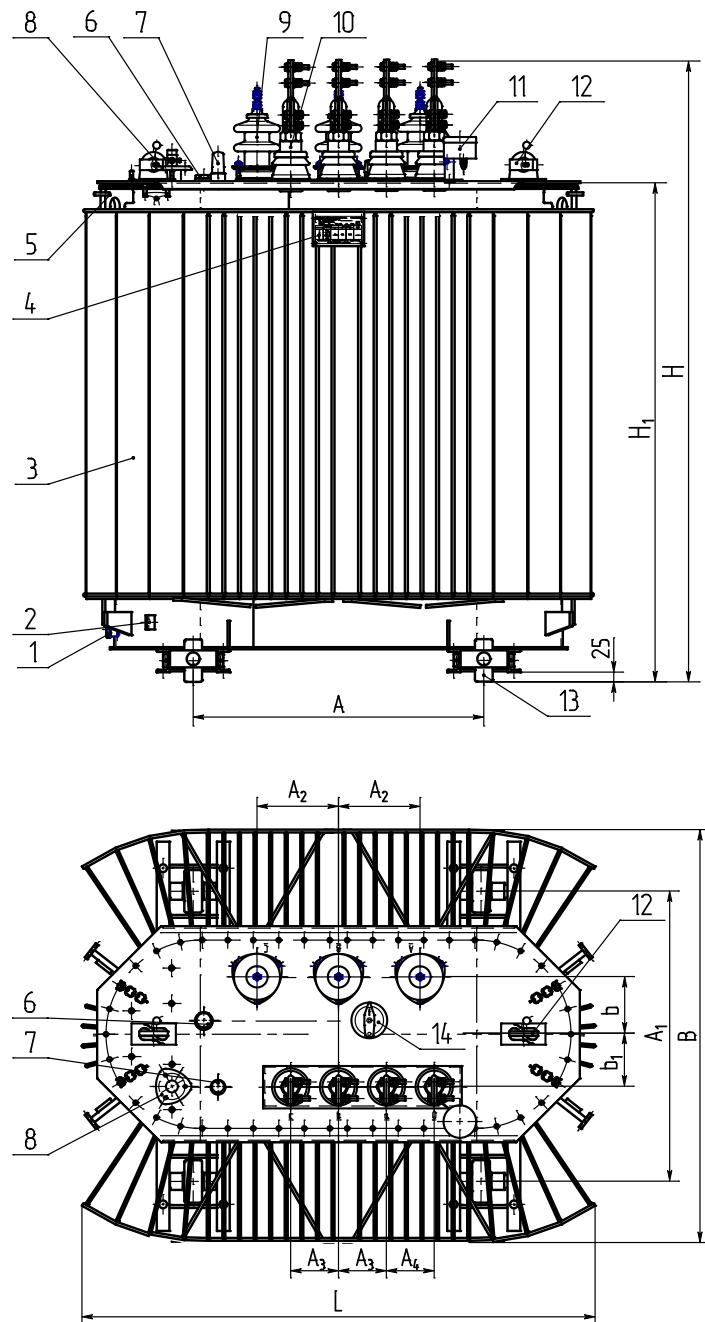
1 - пробка сливная; 2 - зажим заземления; 3 - бак; 4 - табличка;
