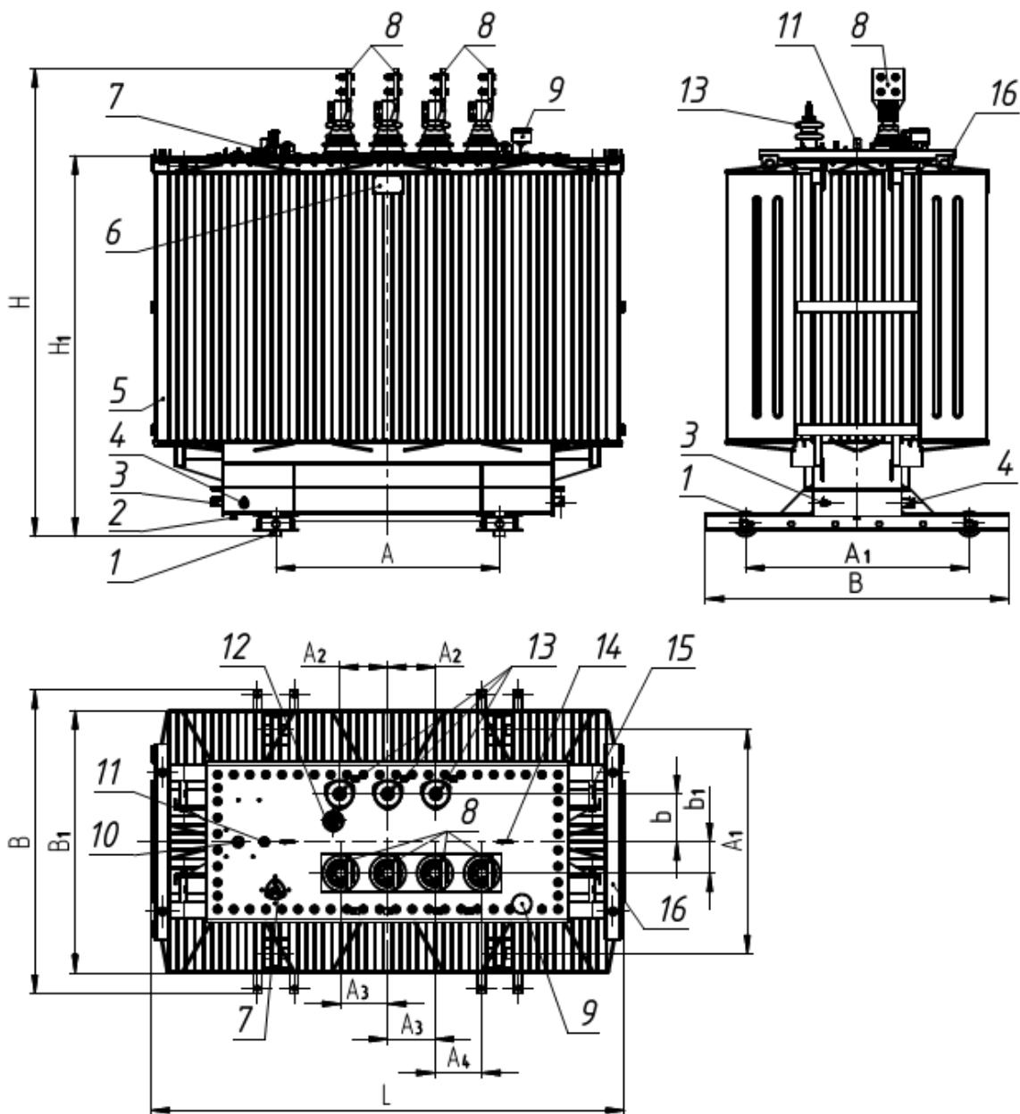
1 - ролик транспортный; 2 - пробка для удаления продуктов окисления и остатков масла; 3 - зажим заземления; 4 - пробка для слива масла; 5 - бак; 6 - табличка; 7 - патрубок для заливки масла; 8 - ввод НН; 9 - пробивной предохранитель (устанавливается по заказу потребителя); 10 - термометр жидкостный; 11 - маслоуказатель; 12 - привод переключателя; 13 - ввод ВН; 14 - серьга для подъема крышки; 15 - узел для подъема трансформатора; 16 - узел для крепления трансформатора при транспортировании
