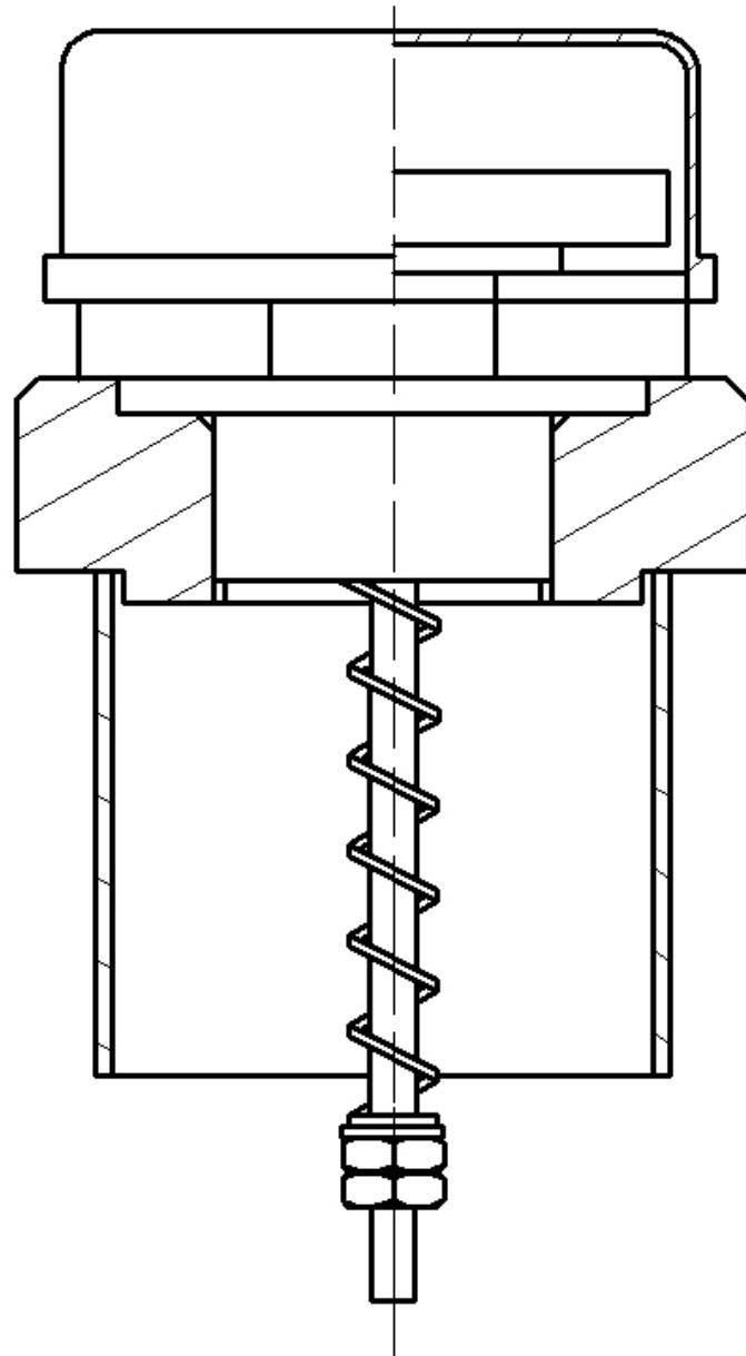
Рисунок А.15 – Предохранительный клапан сброса давления
