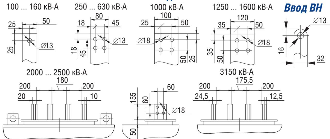
**Трансформаторы ТСЗГЛ, ТСДЗГЛ мощностью 100...2500 кВ·А
